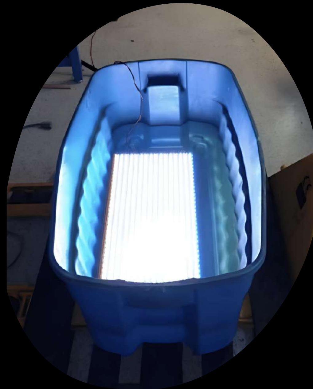
Prova di immersione e doccia salina
